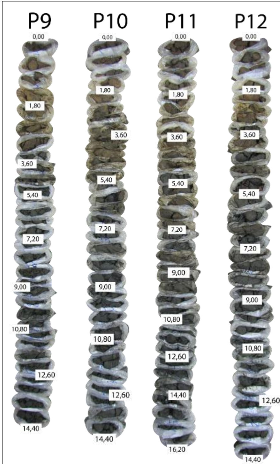
Figura 3.5 Muestras de perforación SPT sondeos P9, P10, P11 y P12.
